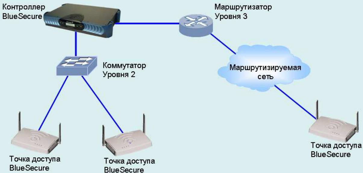
Точки доступа BlueSecure автоматически конфигурируются через любую L2/L3 сеть, используя Bluesocket Discovery Protocol. Это обеспечивает простую модернизацию к новым стандартам, функциям и возможностям и гарантирует длительное время работы без какого-либо физического вмешательства
